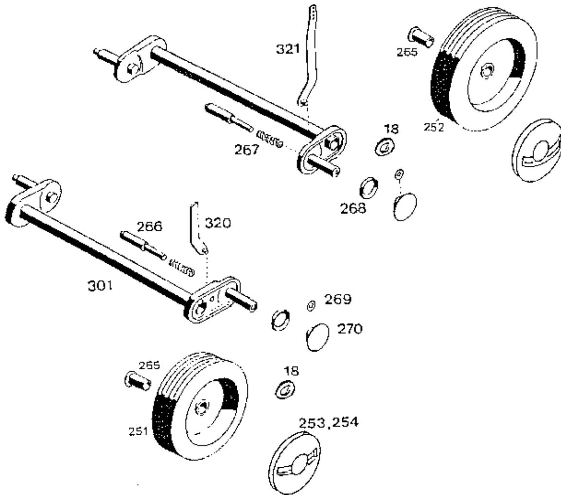
**Gerät: 2.42 B (Achse, Höhenverstellung, Räder)**
