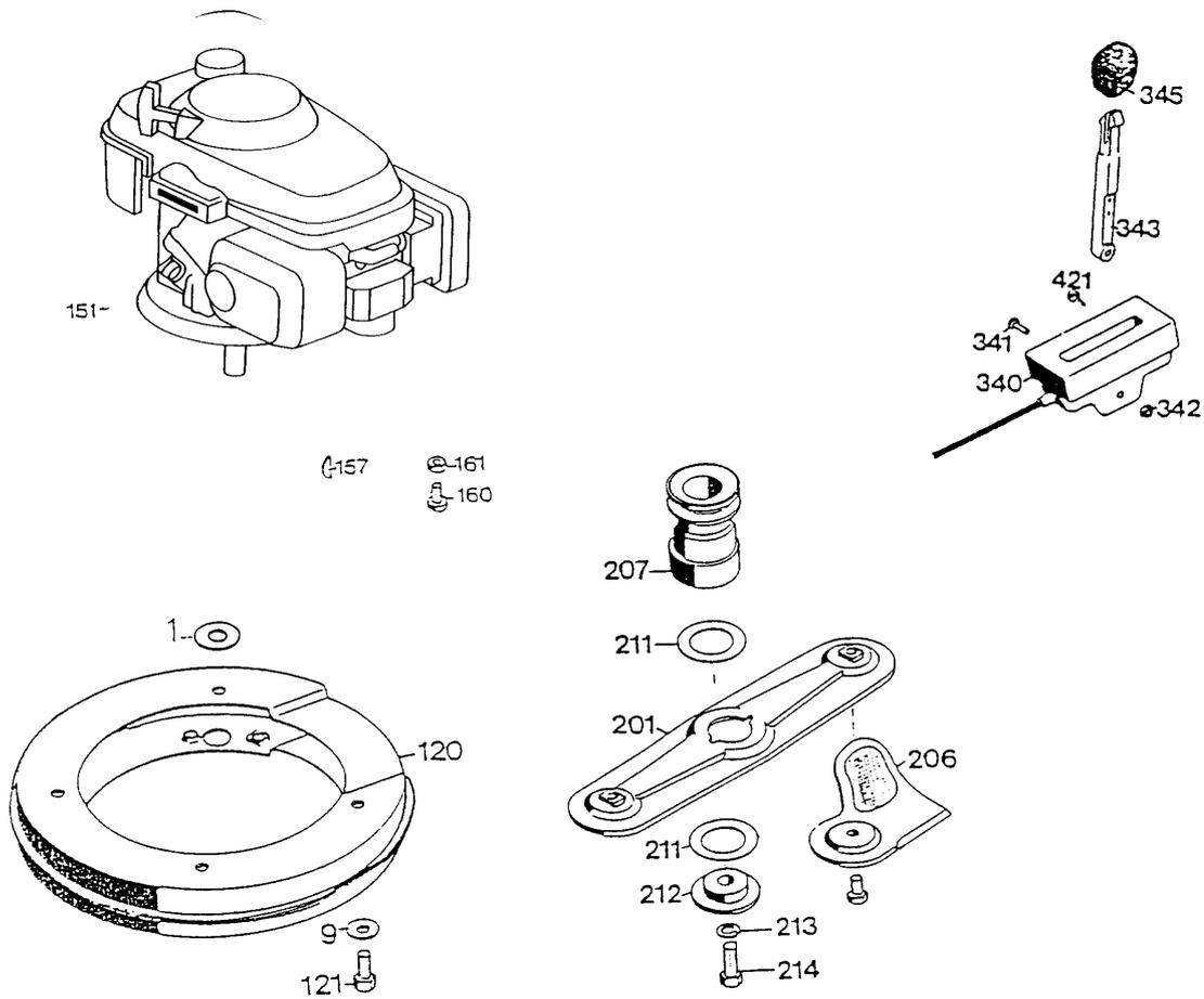
**Gerät: 6.42 H (Zwischenring, Motor, Messerbalken, Schaltgehäuse)**
