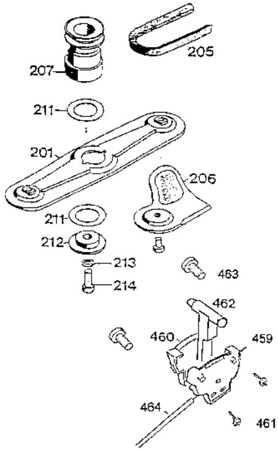
**Gerät: 6.42 BAi (Zwischenring, Motor, Messerbalken, Schaltgehäuse)**
