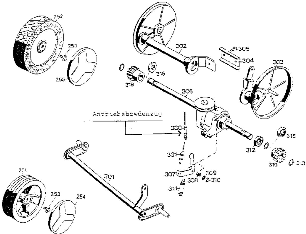
**Gerät: 6.42 BA (Antrieb und Räder)**
